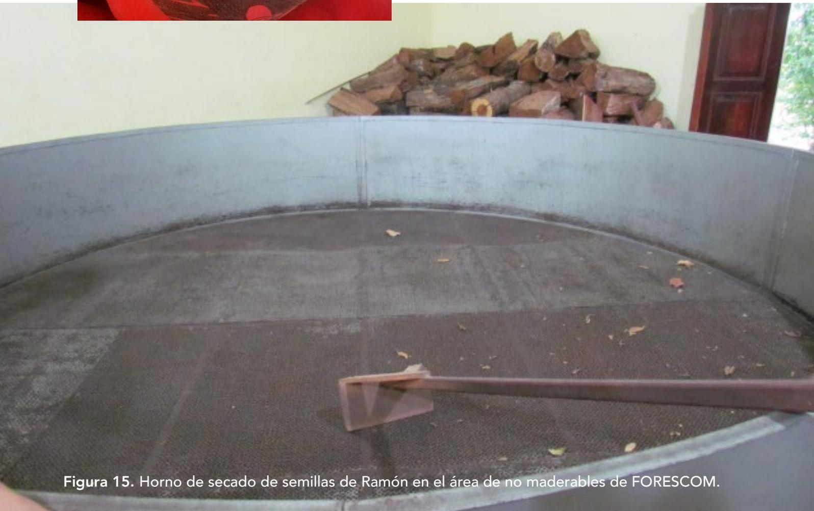
Figura 15. Horno de secado de semillas de Ramón en el área de no maderables de FORESCOM.
